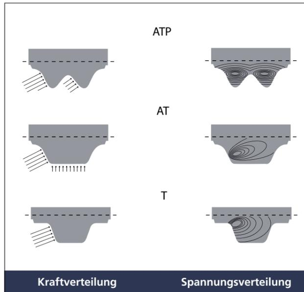
Wenn in der Auslegung die Bedingungen für Zahntragfähigkeit (1.), für die Seilzugfestigkeit (2.) und für die Biegewilligkeit (3.) erfüllt sind, ist ein wartungsfreier Zahnriemenbetrieb zu erwarten.
