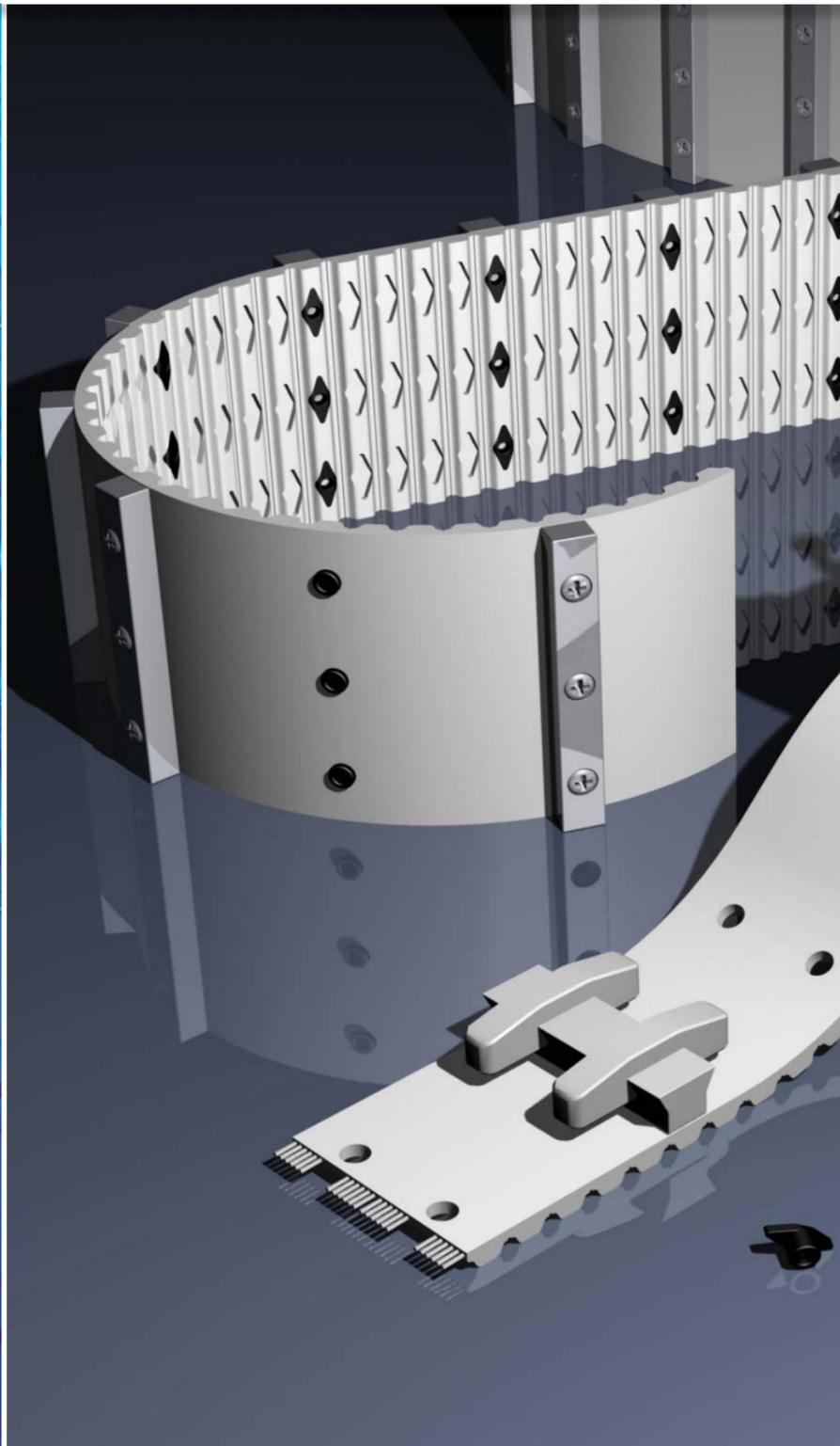
**BRECOFLEX:** Der BRECOFLEX®-Zahnriemen wird in Endloslängen ohne Zugträgerunterbrechung gefertigt. Der Zugträger ist gewindeförmig gespult. BRECOFLEX®-Zahnriemen sind universell einsetzbar für alle Aufgaben in der Antriebstechnik bis 10.000 min<sup>-1</sup>.
