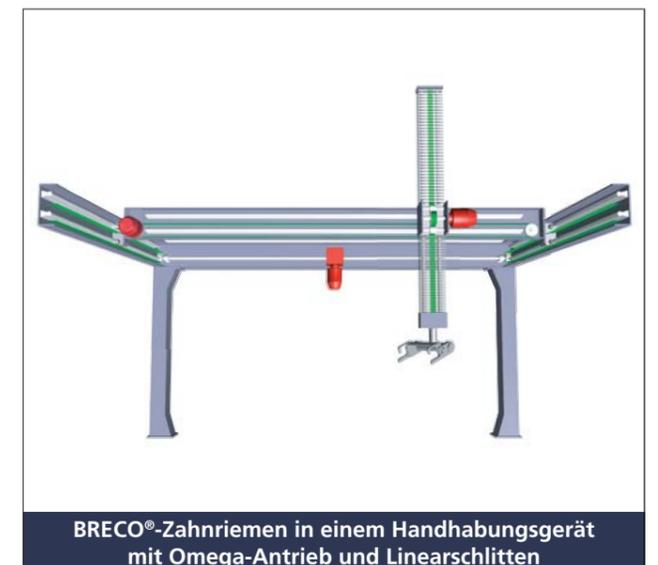
BRECO®-Zahnriemen in einem Handhabungsgerät
